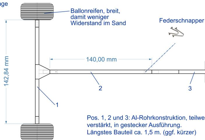
Pos. 1, 2 und 3: Al-Rohrkonstruktion, teilweise mit Knotenbleche verstärkt, in gesteckter Ausführung.
